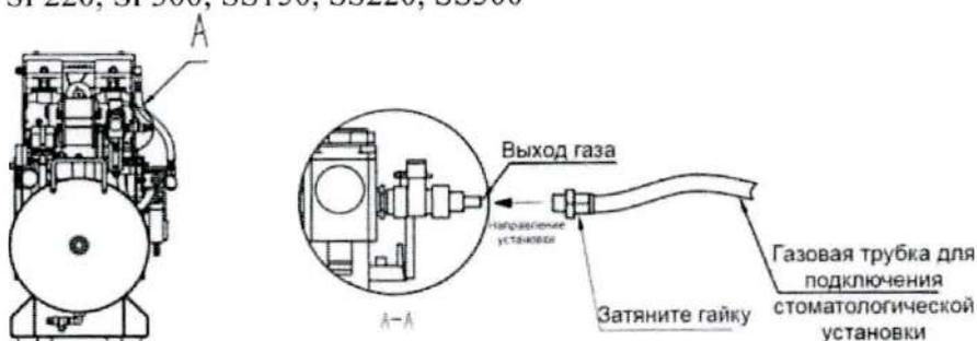
Подсоедините газовую трубку, соединяющую стоматологическое кресло, к газовому выходу компрессора и затяните гайку.
